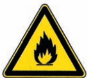
4.1. Degoša viela vai ugunsbīstama telpa
