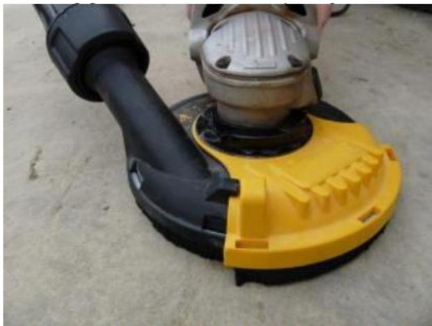
Smalcināšanas ierīce ar atsūkņēšanu no instrumenta (avots: HSE, Lielbritānija).
